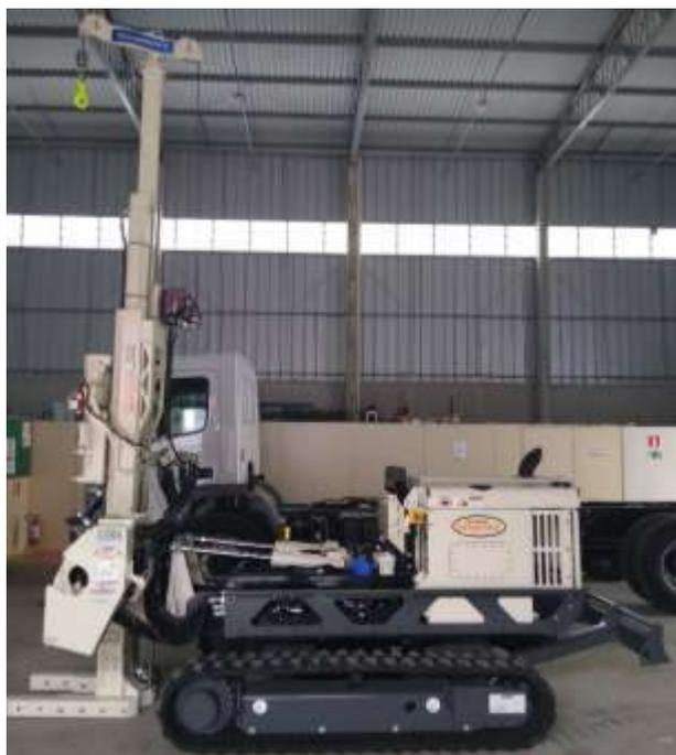
**Figura 1:** sonda GeoProbe™ utilizada para investigações de alta resolução.
