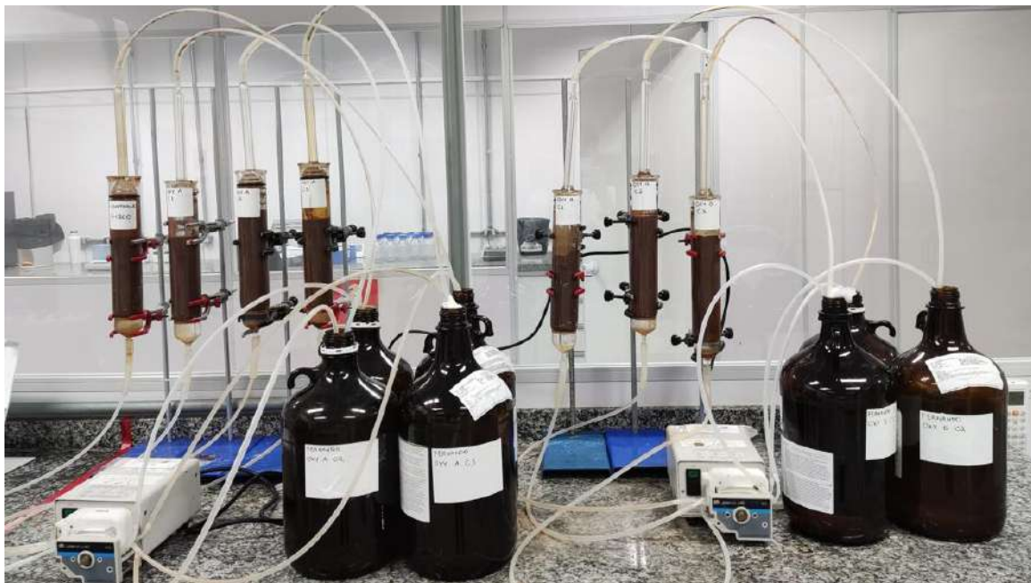
Figura 1: ensaio S-ISCO montado em bancada, mostrando as sete colunas de solo e as soluções remediadoras.
