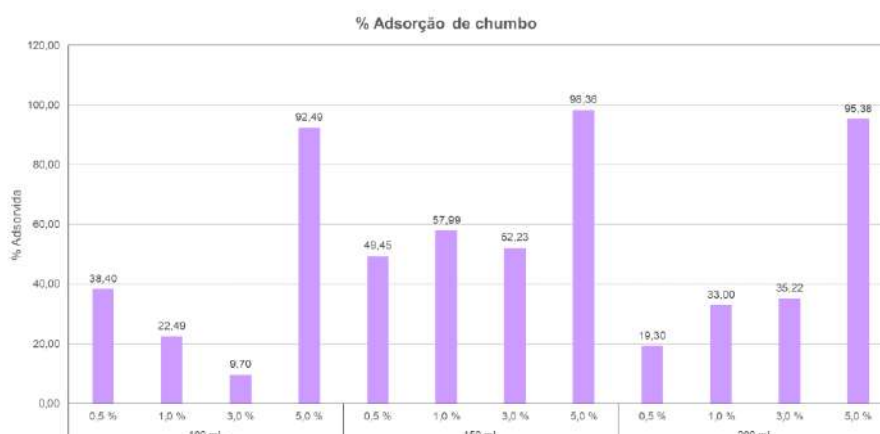
Imagem 02: porcentagem de adsorção de chumbo em barreiras de 0,5 %, 1,0 %, 3,0 % e 5,0 % de CarbonGEO.
